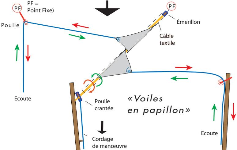
La voile d'ombrage est emmagasinée par le câble anti-torsion central. Il est actionné par le tambour d'emmagasineur grâce au bout sans fin.
